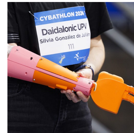
Upper 2 An AI-driven myoelectric prosthetic arm enhancing user adaptability, Universitat Politècnica de València
